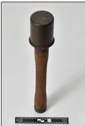
Figuren 28 en 29. Voorbeeld van een Duitse (steel)handgranaat (links) en een Panzerfaust (granaatwerper, rechts). Dergelijke CE kunnen worden aangetroffen ter plaatse van loopgraven, wapenopstellingen en schuttersputten. Bron: collectie BeoBOM.
